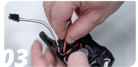
03 Insert the 4010 hotend cooling fan
