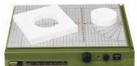
Helppo ja tehokas ratkaisu ympyränleikkaukseen: Pöytään kiinnitetään teipillä painonasta, joka toimii kiertopisteinä.
